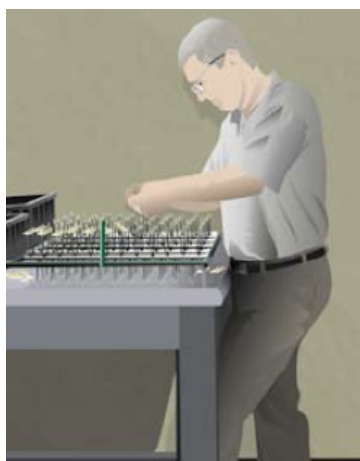
Figura 25 – Colocação de peças na gancheira Fonte: SESI, 2007
